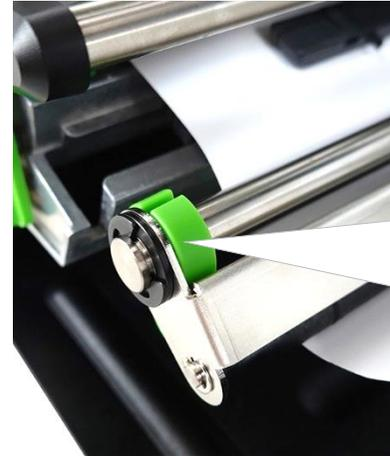
5. Passen Sie die Medienführung so aus, dass die Position der Führung an der Breite des Mediums ausgerichtet ist.
