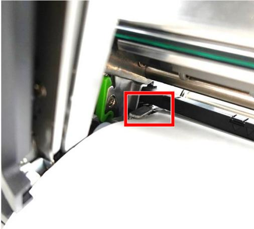
4. Richten Sie das Medium an der Medienführung aus. Achten Sie darauf, dass das Medium unter der Führung eingefädelt ist.
