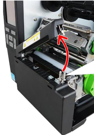
2. Öffnen Sie die obere Stange für das trägerbandlose Schnitt- (oder Abzieh-) Modul.
