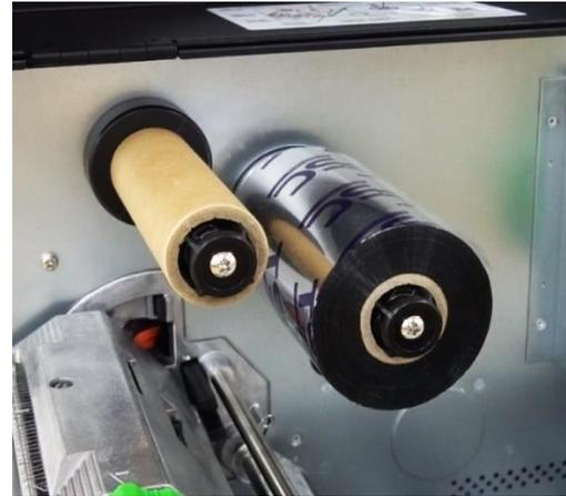
2. Schieben Sie das Farbband auf die Farbbandzufuhrspindel, bis sie mit dem Flansch bündig ist.
