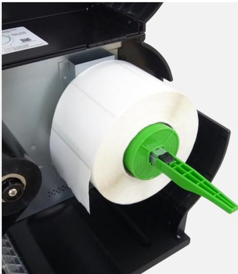
3. Platzieren Sie die Medienrolle an der Etikettenversorgungsspindel (mit 3-Zoll-Kernadaptern) und drücken Sie sie zum Ende der Spindel.
