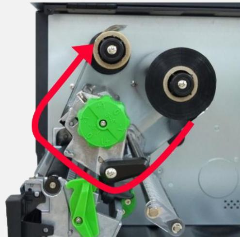
5. Fädeln Sie das Farbband durch den offenen Bereich zwischen Druckkopf und Ausgabewalze ein. Ziehen Sie dann das Farbband am Papierkern.
