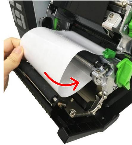
9. Führen Sie die Vorderkante des Tragbands wie abgebildet durch den Abziehmodulschlitz.
