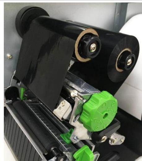
6. Wickeln Sie das Farbband auf die Aufwickelspindel. Halten Sie das Farbband flach und faltenfrei.
