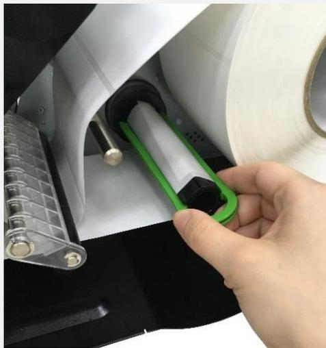
10. Ziehen Sie die Sicherungsklemme (grün) heraus. Wickeln Sie das Tragband auf die Spindel, bis das Tragband angemessen gestrafft ist.
